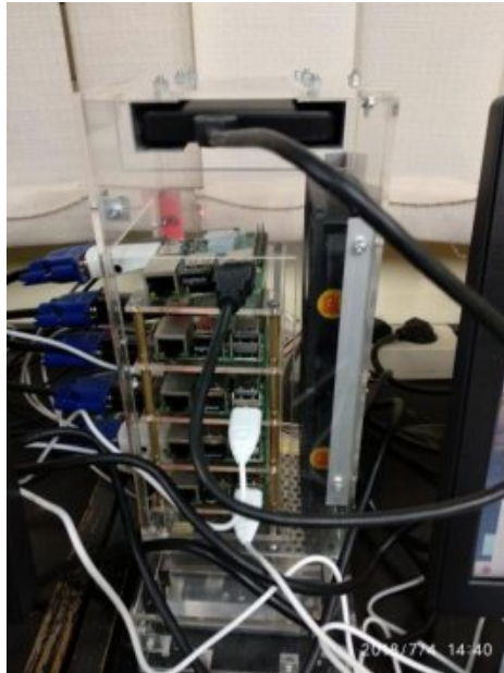
Gambar 1. Raspberry Pi dalam rak setara dengan 5 buah komputer mini.
